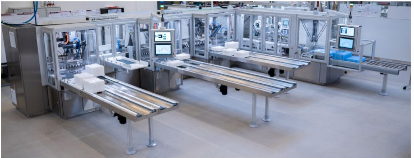
Une ligne flexible de stylos-injecteurs qui assemble différents formats et intègre nombreux contrôles "in-line" A flexible pen injector line, assembling different formats and integrating extensive in-process controls.
