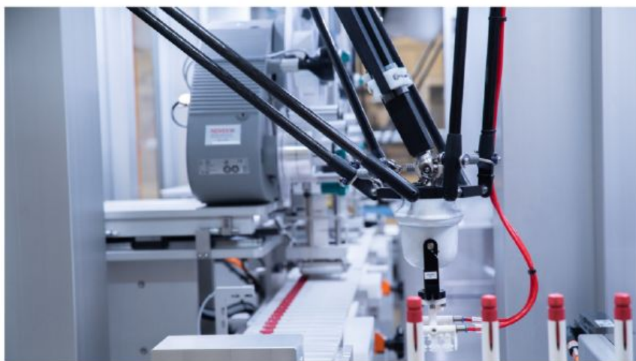
Ligne d'assemblage de stylos-injecteurs Pen injector assembly line
