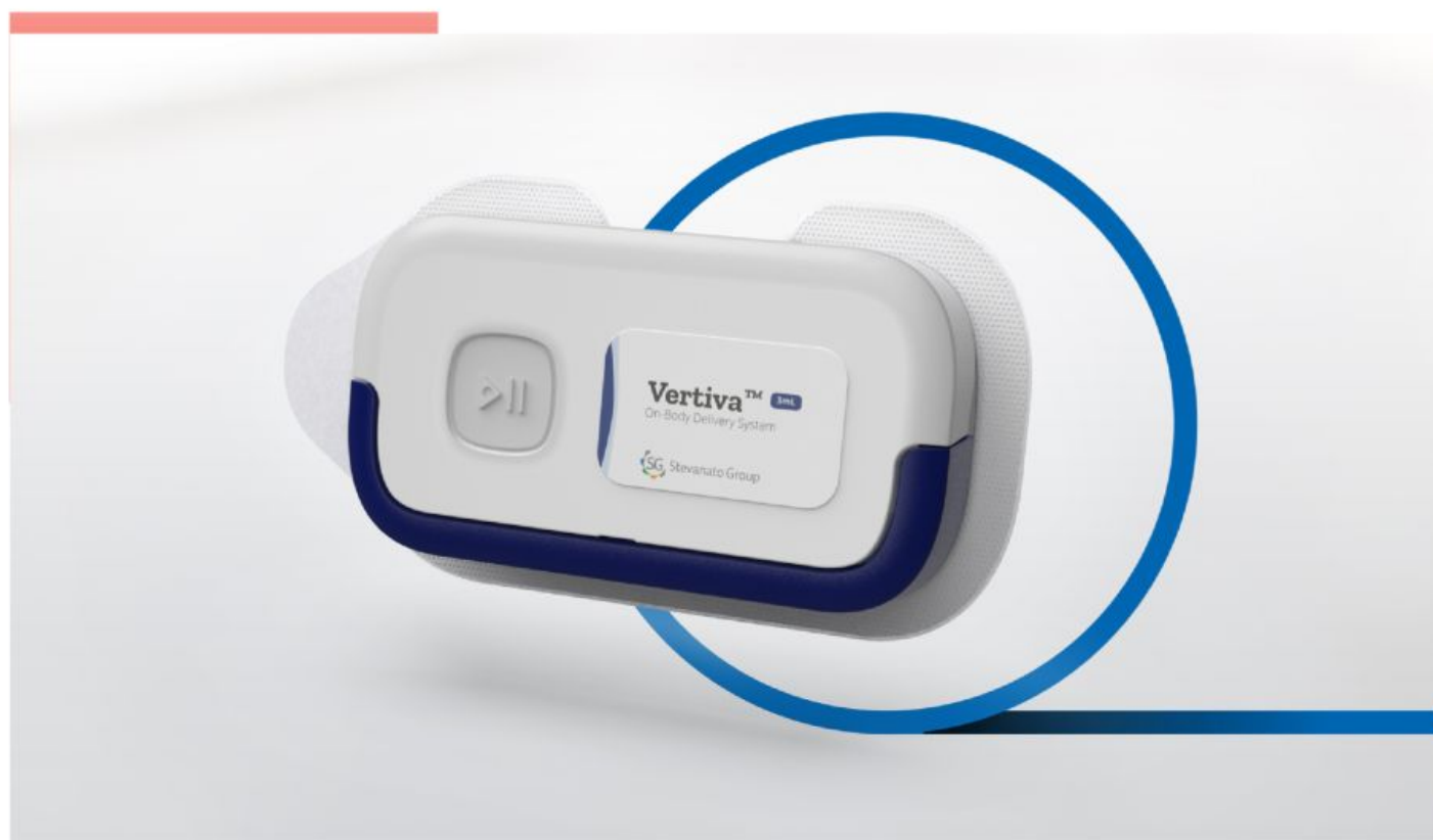
Vertiva™ associe un pod à usage unique avec une cartouche préremplie et préchargée, avec un contrôleur intelligent à usage multiple.
